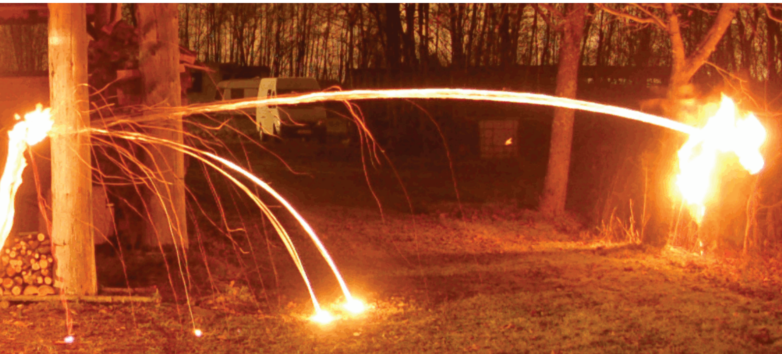
Pilt 5. Varasemas eksperimentis kasutatud (kuumem) süütesegu pritsis sihtmärgini jõudes palju põlevat süütematerjali. Foto: Elmo Jõeleft.
